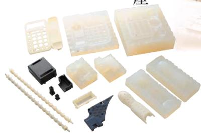
切削加工や光造形システムで製作した、マスターモデルからシリコン型を作成します。出来たシリコン型を真空注型設備に設置し、用途に応じた素材を脱泡後、流し込み、複製を量産します。
